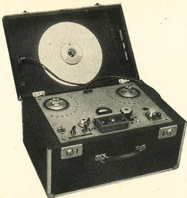
Die Abbildung zeigt: Ein MTG 9-54 AW/K, also ein Koffergerät für Aufnahme und Wiedergabe. Bei der Ausführung eines AWL/K befinden sich an der Kofferrückwand der 4 Watt Leistungsverstärker und an der rechten Seitenwand der Kontrolllautsprecher. Rein äußerlich entfallen beim Wiedergabegerät MTG 9-54 W/K, der Mikrofonanschluß, das Aussteuerungsinstrument, der Verstärkerschalter und eine Kontrolllampe.
