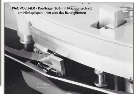
c) Bandschnitt am Hörkopfspalt
