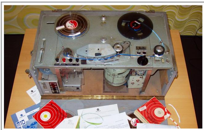
**1956** legt Herr Hermann Heiß mit einem VOLLMER-Tonbandgerät Typ 166 [Foto 2] den Grundstein für sein eigenes Studio in Darmstadt. Die Firma E. Vollmer aus Eßlingen-Mettingen liefert für knapp DM 10.000 eine von Herrn Heiß spezifizierte Sonderanfertigung, die in den kommenden Jahren ständig modifiziert und erweitert wird, bis schließlich das eigenständige **Heiß-Vollmer-System** entsteht.
