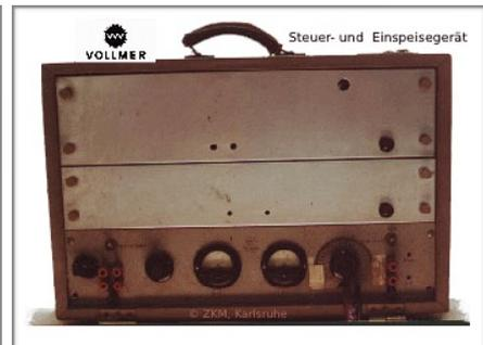
**Kopfträger-Sonderanfertigung (li) und Steuer-/Einspeisegerät für Magnetbandgerät Typ 166 (re)**
